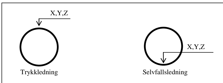
Figur 1. Måling av ledningshøyde.
